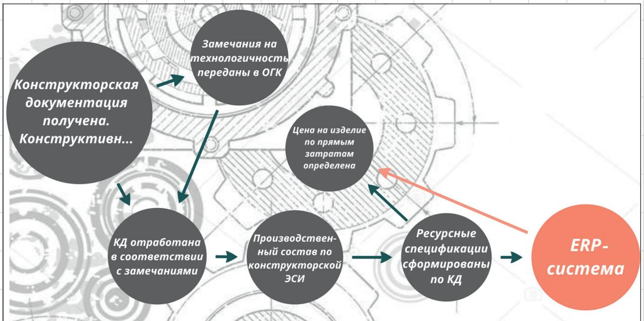
Рис. 3. Конструкторский этап подготовки производства
